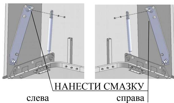
6. Привести каркас кровати в поднятое состояние. Присоединить свободные концы газлифтов поз.38 к осям кронштейнов на коробе, используя гайки M6 со стопорным кольцом поз.23,
