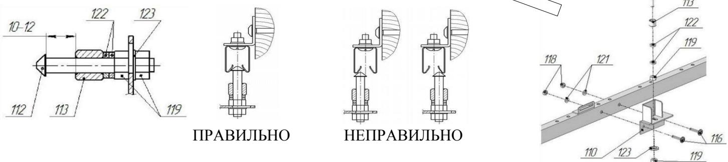
Отрегулировать положение уверенной фиксации рамы в вертикальном положении.
