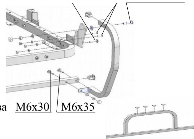
3. Разрезать пополам две накладки войлочных поз.33 и приклейте к штанге опоры СМАЗКУ поз.36. Под гайки установить шайбы  $\varnothing 6 \times 18$  стальные поз.29.
