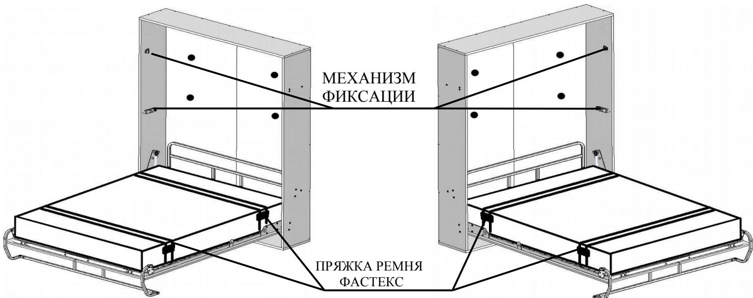
2. Соединить зацеп Фастекс поз. 134 с кронштейнами на противоположной стороне рамы кровати, используя ремень длинный поз. 131 и пряжку пластиковую поз. 133. Схема продевания ремня изображена на эскизе.
