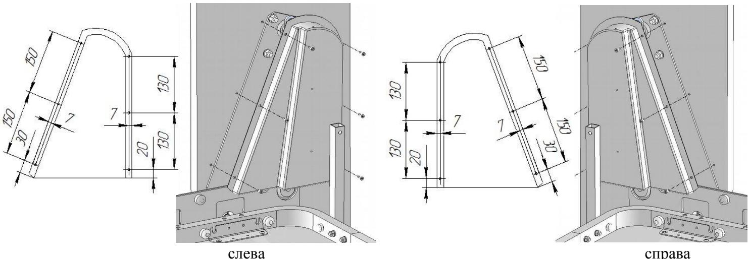
8. Собрать половины шарниров бортиков поз.11, используя Винт M6x25 поз.15, гайку M6 со стопорным кольцом поз.23. В соединении двух шарниров бортика поз.11, под гайки установить шайбы Ø6x12 пластмассовые поз.31.
