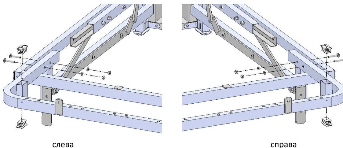
5. Присоединить к кронштейнам штанги поз.7 накладку поз.11, используя винты М6х14 поз.18.
