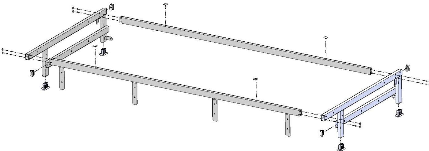
2. Присоединить основание дивана, собранное по пункту 1 к корпусу, используя винты-конфирматы поз.24. Присоединить механизмы левый и правый поз.8,9 к соответствующим боковинам поз.4,5, используя винты М6х20 поз.19.
