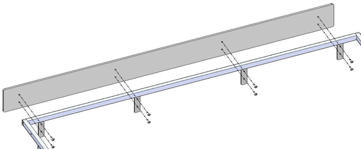
6. Присоединить к раме передней поз.1 накладку поз.10, используя винты М6х14 поз.18. Ремень накладки установить в соответствии с рисунком. Собрать латофлексы поз.25 с латодержателями поз.26 и установить на раму дивана. Латодержатели должны входить в отверстия зацепами полностью (до щелчка).
