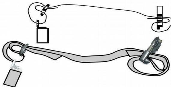
3. Уложить матрас на раму кровати. Соединить соответствующие зацепы и гнезда Фастекс. Отрегулировать длину ремней для максимального натяжения.
