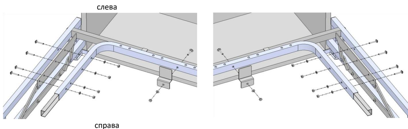
4. Присоединить раму переднюю поз.1 к соединителям поз.3, используя винты М6х35 поз.20, шайбы поз.22, гайки поз.21. Вставить в отверстия стоек рамы поз.1 заглушки поз.27.
