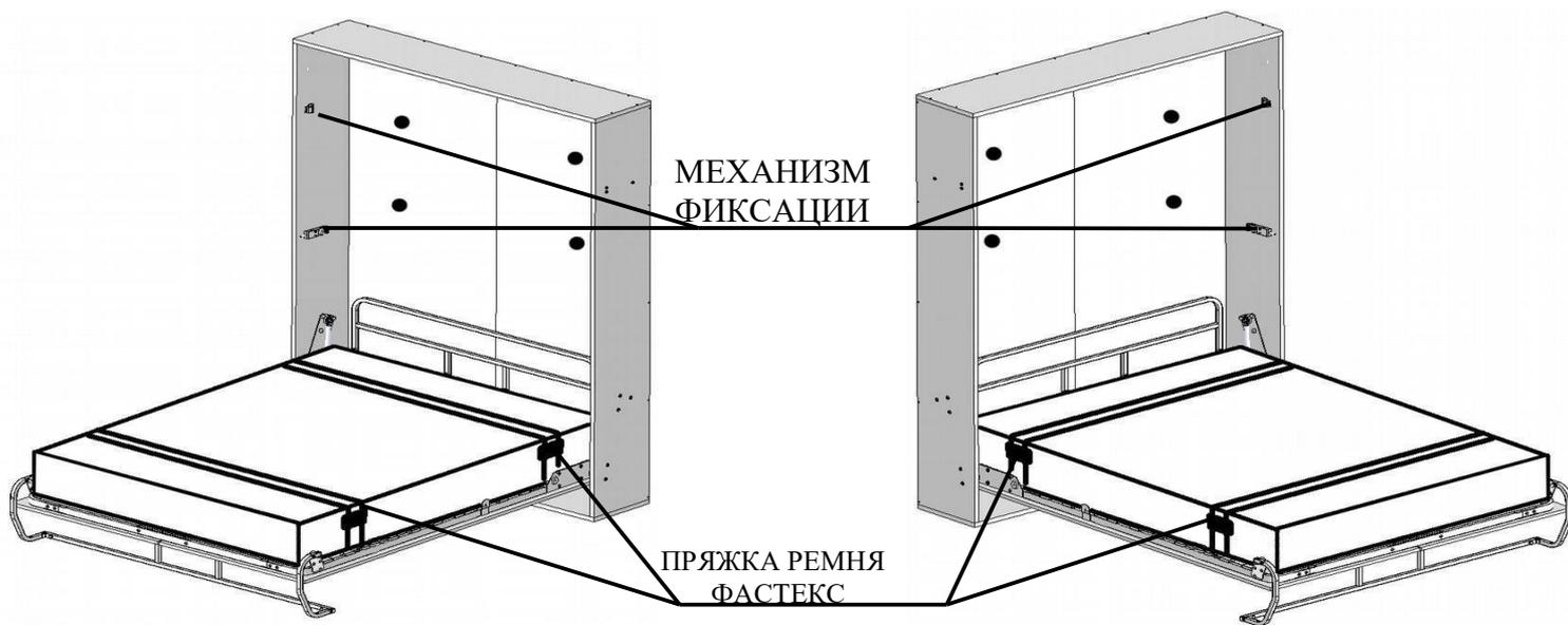
2. Соединить зацеп Фастекс поз. 134 с кронштейнами на противоположной стороне рамы кровати, используя ремень длинный поз. 131 и пряжку пластиковую поз. 133. Схема продевания ремня изображена на эскизе.
