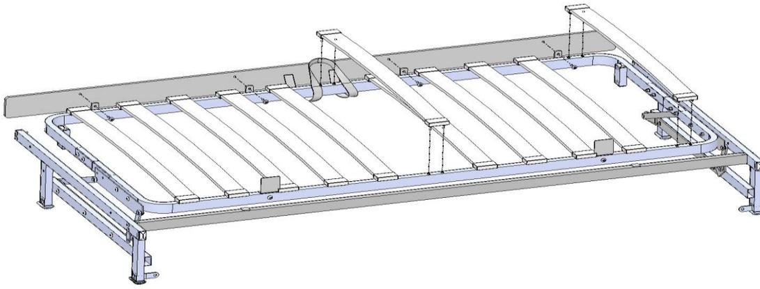
7. Присоединить подлокотники поз.12,13 с помощью уголков поз.15 к боковинам короба в соответствии с рисунком, используя саморезы 4x20 поз.23. Привести раму дивана в сложенное вниз положение. Присоединить подлокотники поз.12,13 к раме дивана, используя винты М6х20 поз.19 и винты М6х35 поз. 20 в соответствии с рисунком.
